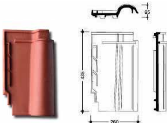
Рис. 23. План черепицы, поперечный и продольный разрезы.
