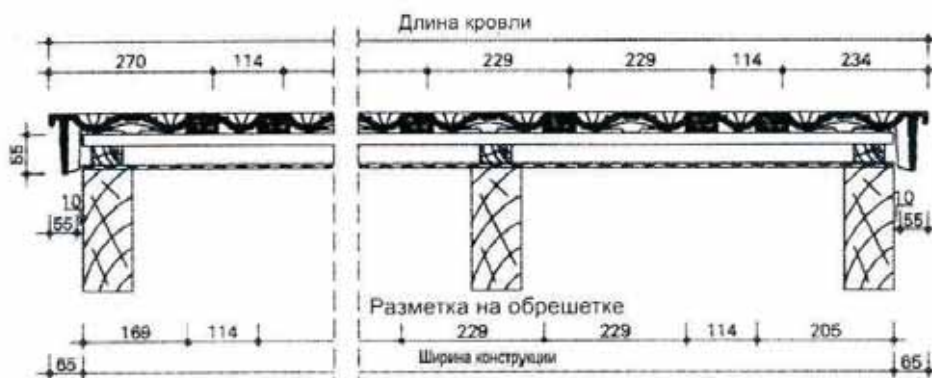
Рис. 13. Продольный разрез кровли с применением на фронте боковой черепицы (левой и правой)
