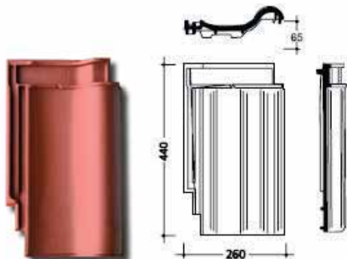
Рис. 8. План черепицы, поперечный и продольный разрезы.
