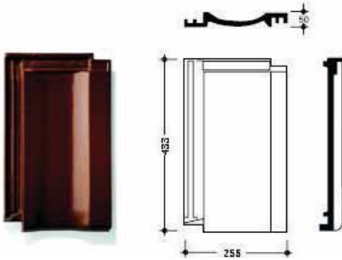
Рис. 14. План черепицы, поперечный и продольный разрезы.
